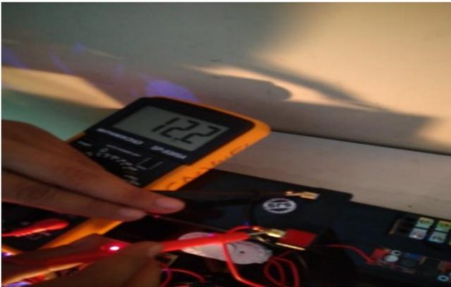
Gambar 1 Pengujian Sensor Tegangan Baterai
