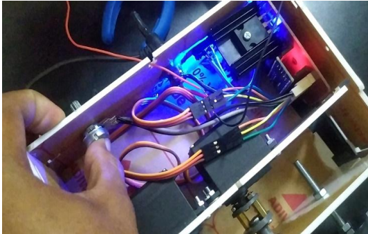
Gambar 10 : Pengujian terhadap output pwm pada servo motor
