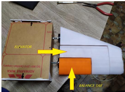
Gambar 8: Alat Peraga Balance Tab pada Elevator Movement
