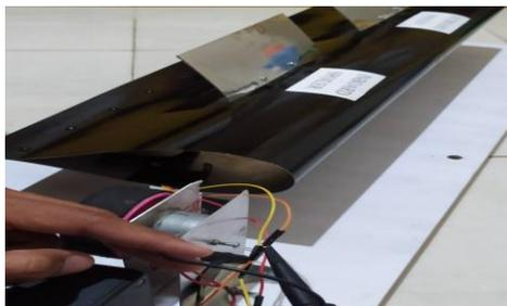
Gambar 12 Pengujian terhadap output pwm pada servo motor
