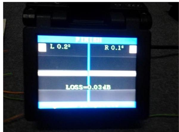
Gambar 1 Penyambungan FO dengan OTDR
