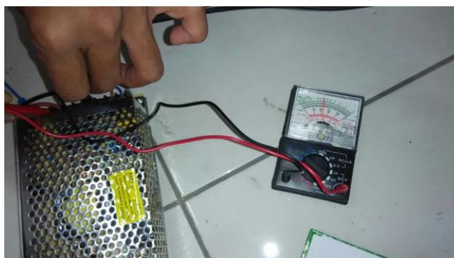
Gambar 1. Hasil Pengukuran Tegangan Power Supply
