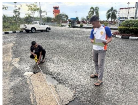
Gambar 1 Survei Luasan Kerusakan Jalan Akses
