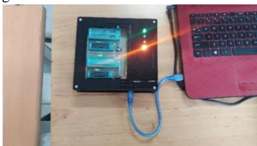
Gambar 9 Tampilan alat saat memprogram IC Atmega 8
