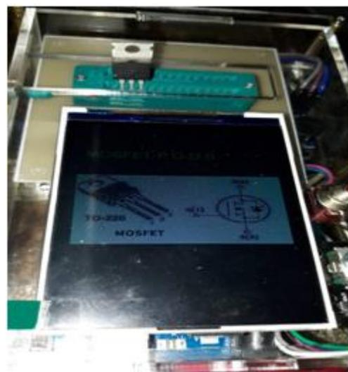
Gambar 6. Pengujian Mosfet
