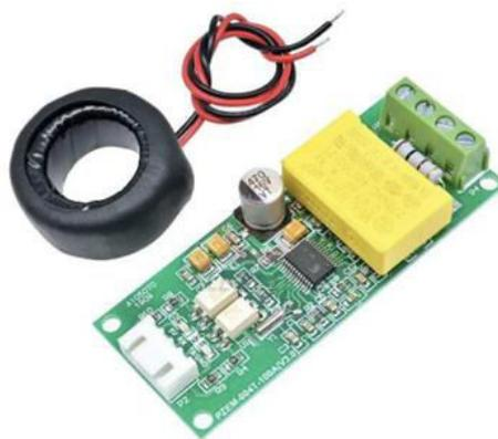
Gambar 2. Sensor Tegangan dan Arus PZEM -004T
