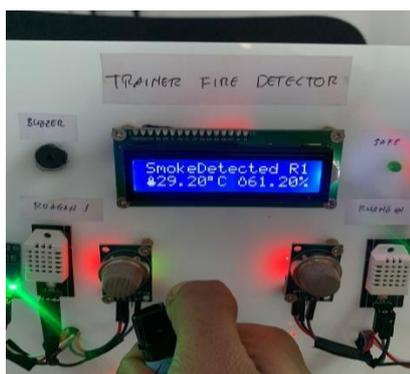
Gambar 6 Pengujian Sensor Asap/Gas Ruang 1
