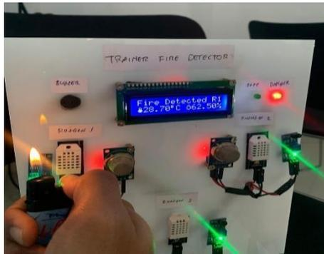
Gambar 5 Pengujian Sensor Api Ruang 1
