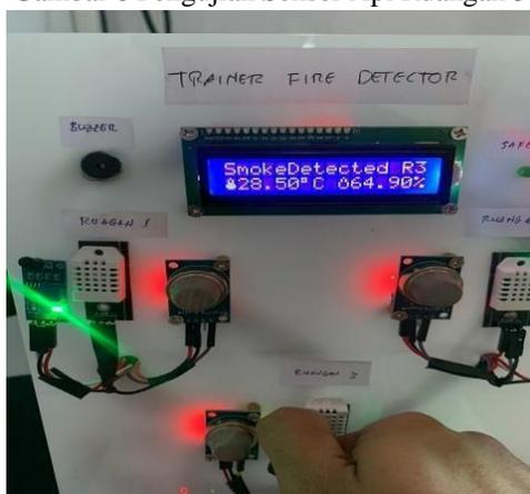
Gambar 8 Pengujian Sensor Asap/Gas Ruang 3
