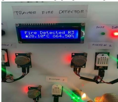
Gambar 8 Pengujian Sensor Api Ruang 3
