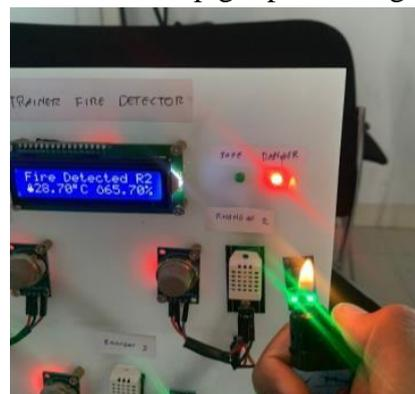
Gambar 6 Pengujian Sensor Api Ruang 2
