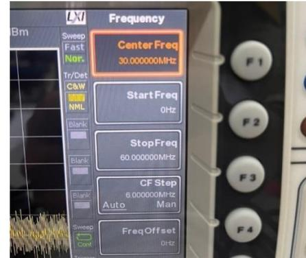
Gambar 9 Set frekuensi pada *Spectrum Analyzer*
