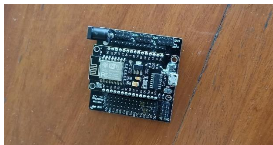
Gambar 6 Implementasi Shield Pada Node MCU
