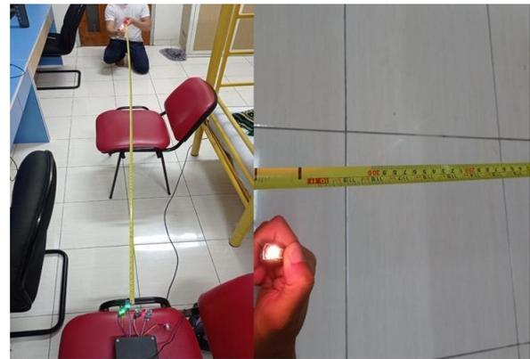
Pengukuran sensitivitas sensor      Jarak pengukuran lebih dari 330 cm
