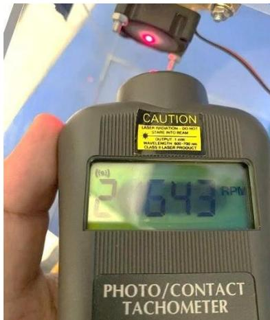
**Gambar 12.** Pengukuran RPM Fan
