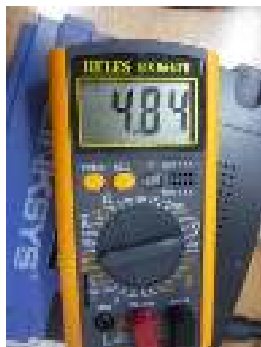
Gambar 4. Pengujian Tegangan Input Raspberry Pi
