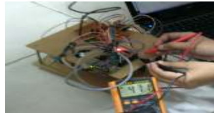
Gambar 8. Pengukuran Output Tegangan Pin GPIO
