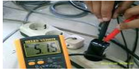
Gambar 7. Pengukuran Tegangan pada Adaptor Power Supply
