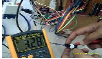
Gambar 11. Pengukuran tegangan buzzer pada rangkaian saat buzzer on.
