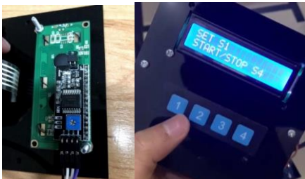
Gambar 13 LCD I2C 16x2 Yang Dipasang di Sisi Tutup Box dan Tampilan Sisi Tutup Box
