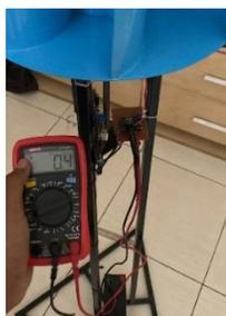
Gambar 4.9 Pengujian Tegangan Output Dinamo menggunakan Avometer
