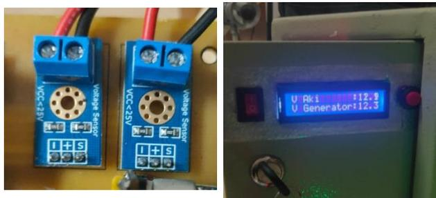
Gambar 16 Pengujian Pada Sensor Tegangan
