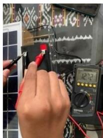
Gambar 4. Pengujian Baterai dan SCC
