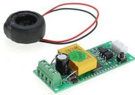
Gambar 2. 4 Sensor PZEM-004T([mikroavr.com](http://mikroavr.com))
