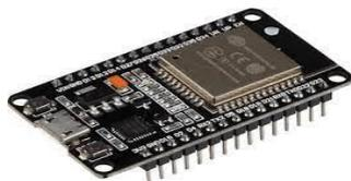
Gambar 2. 3 ESP32 (katalog mikrokontroler.COM)
