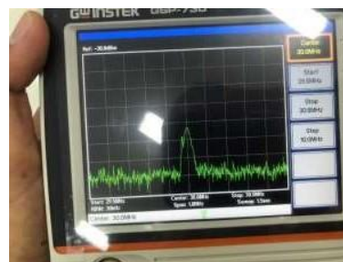
Gambar 9 Frekuensi 30 MHz ditunjukkan Spectrum Analyzer
