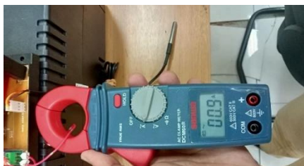
Gambar 12 Pengujian Sensor Arus ACS712
