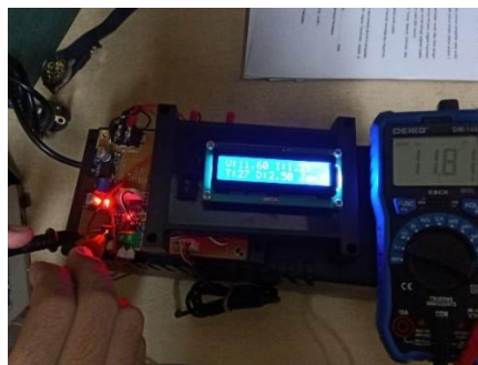
Gambar 10 Pengujian Sensor Tegangan
