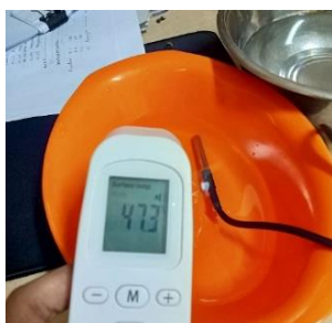
Gambar 8 Pengujian Sensor Suhu DS18B20
