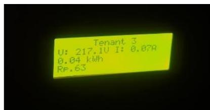
Gambar 7. Hasil Pengujian LCD Tenant 3
