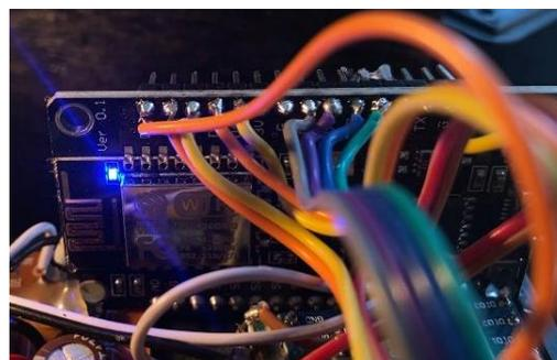
Gambar 7. Kondisi Mikrokontroler ESP8266 ketika Terhubung Wifi
