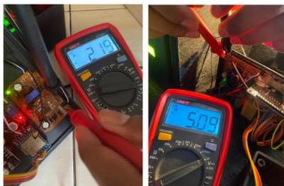
Gambar 4. Hasil Pengujian Input dan Output Rectifier
