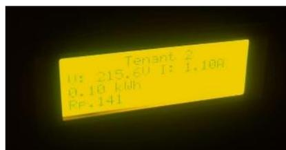
Gambar 6. Hasil Pengujian LCD Tenant 2
