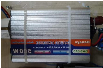
Gambar 2.8 Power Inverter Sumber: Penulis
