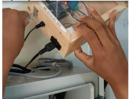
Gambar 4 Pemasangan Kabel Power, adaptor dan LAN
