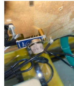
Gambar 14. Sensor MQ-2 pada prototype
