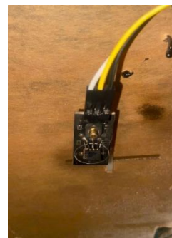
Gambar 8. Sensor DS18B20 pada prototipe
