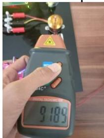
Gambar 6. Pengujian Sensor Kecepatan
