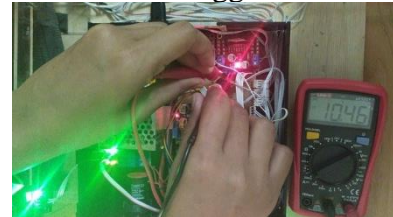
Gambar 10 Pengujian pada tegangan input L298N
