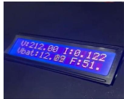
Gambar 4. 2 Pengujian sensor Pzem 004 t
