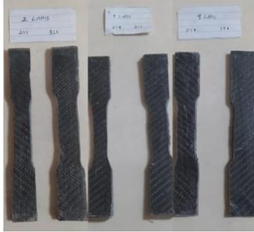
Gambar 3. Spesimen Uji Tarik
