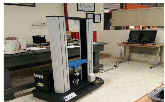
Gambar 4 Mesin Uji Tarik.
