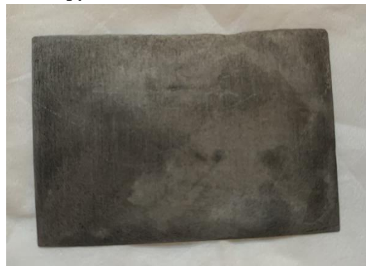
Gambar 10 Korosi pada alumunium 1100 dengan larutan HCl
