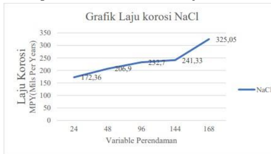
Gambar 11. Grafik Laju Korosi Aluminimum 2024 pada Larutan Natrium Clorida dengan Heat Treatment
