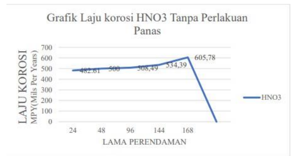
Gambar 5. Grafik Laju Korosi Aluminium 2024 Pada Larutan Asam Nitrat Non Heat Treatment
