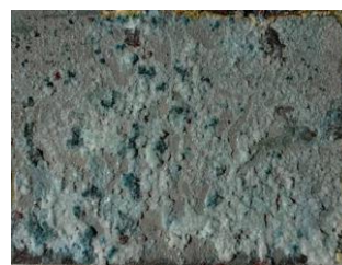
Gambar 6. Aluminium 2024-T3 terkorosi dengan waktu heat treatment 1 jam perendaman selama 168 jam
