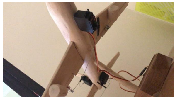
Gambar 10. Pengujian Akurasi Derajat Rudder
