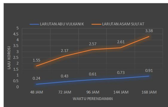
Gambar 7. Perbandingan laju korosi antara larutan asam sulfat dan larutan abu vulkanik
