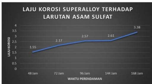
Gambar 5. Perbandingan laju korosi superalloy pada larutan asam sulfat
