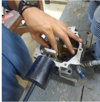
Gambar 17 Pemasangan Special Tool
