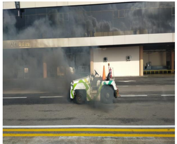
Gambar 5 GSE yang Mengeluarkan Asap Saat Beroperasi di Service Road
