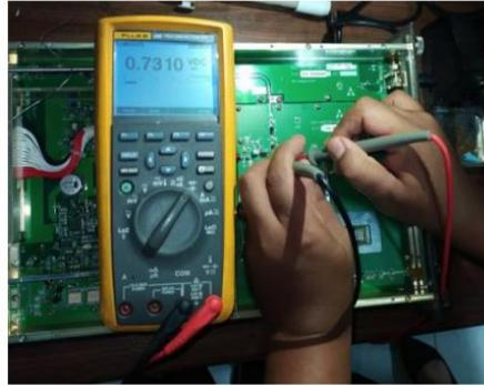
**Gambar 6.** Pengukuran Tegangan Komponen Mosfet
