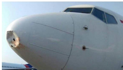
Gambar 7. Moncong pesawat LNI 823 yang penyok setelah menabrak burung.
