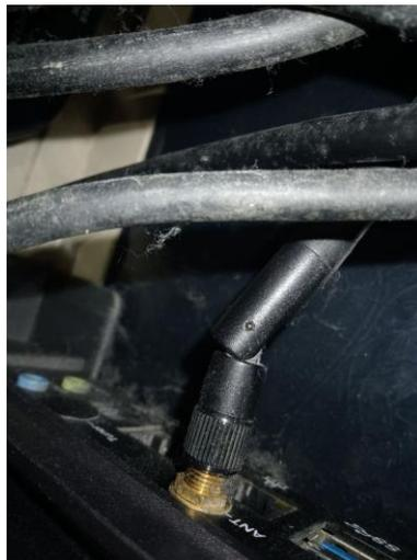
Gambar 3 *Dongle Wi-Fi* terpasang pada *mini PC*
