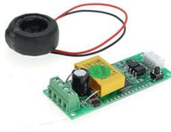
**Gambar 2.** Sensor PZEM-004T([mikroavr.com](http://mikroavr.com))
