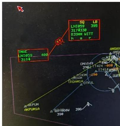
**Gambar 4.** Contoh *double target* pada ADS-B
