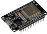
**Gambar 3.** Mikrokontroler ESP32
