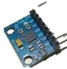
**Gambar 6.** Modul Akselerometer
