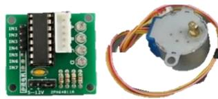
**Gambar 8.** Driver ULN2003 dan motor stepper 28BYJ-4.
