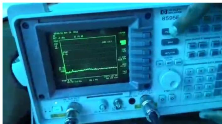
Gambar 3. Tampilan Range Frekuensi pada Spectrum Analyzer
