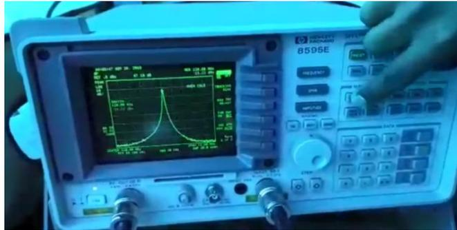
**Gambar 6.** Tampilan Marker pada Puncak *Bandwidth*
