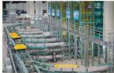
Gambar 4. Sistem Otomatisasi Early Bag Store (EBS) yang menggunakan Baggage Handling System
