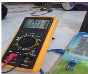
Gambar 3 Pengujian Sensor Arus
