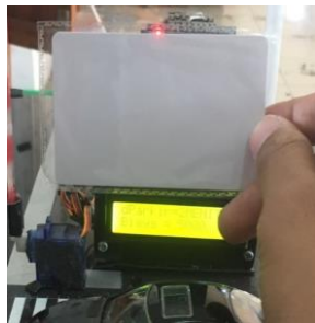
Gambar 5 Pengujian Pada Tag RFID dan RFID Reader
