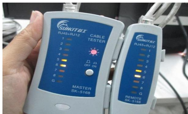
Gambar 4. Pengujian kabel LAN
